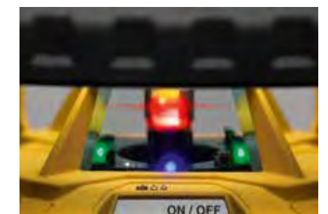
LED ASSIST System mit Kontrollanzeigen.
